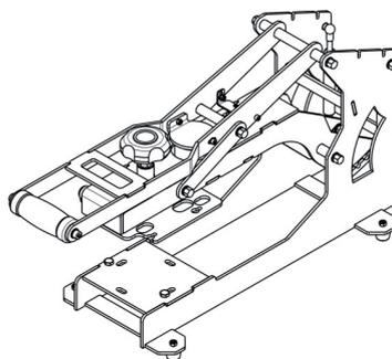
Heizplatte und Basisplatte
