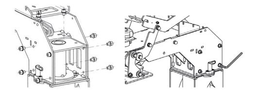
• Entfernen Sie die Schrauben vom Hebel.
