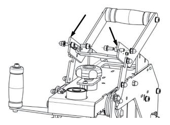
• Bewegen Sie den Hebel nach vorne und befestigen Sle diesen mit den Schrauben.
