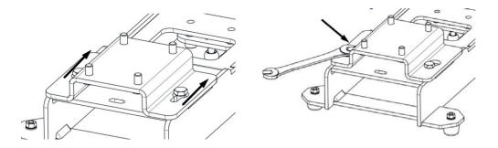
• Bringen Sie die Heizplatte **HP7** schräg vor dem Anschluss-Flansch unterhalb des Presshebels an der **heat press base** in Stellung und Fädeln Sie die 4 außenliegenden Schraubenköpfe in die Schlüsselloch-Fräsungen an der Flanschplatte ein.
