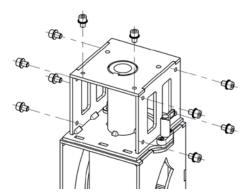
• Verbinden Sie die heat press base mit dem heat press head wie unten dargestellt.
