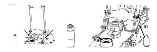
• Verbinden Sie die Grundplatte mit dem Sockel der *heat press base* (nur der Adapter ist sichtbar) und befestigen Sie ihn im Voraus.
