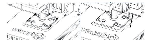
• Ziehen Sie die Schrauben mit dem mitgelieferten Inbusschlüssel vorsichtig fest. Achtung, die Heizplatte kann herunterfallen, solange die Schrauben nicht fest angezogen sind! Verletzungsgefahr!
